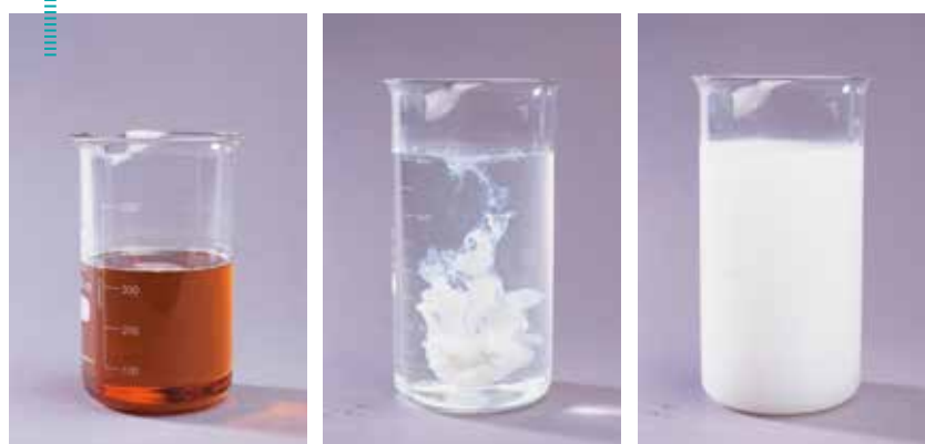
За розведення концентрату емульсії (EC) водою утворюється емульсія, що і є кінцевим продуктом, який надходить у продаж.
