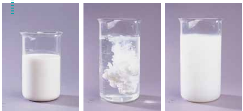
Змішування концентрату суспензії (SC) з водою дає суспензію. Діюча речовина представлена у вигляді тонко розподілених часток.
